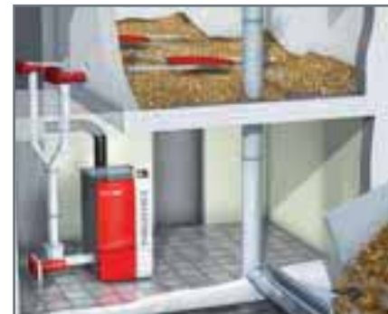
Tube de chute avec bride haute supplémentaire pour raccordement sur raccord double en Y
