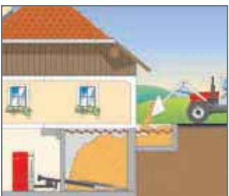
Silo dans la cave de la maison avec vis de remplissage horizontale.
