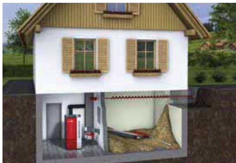
Chaudière et silo en sous-sol :
