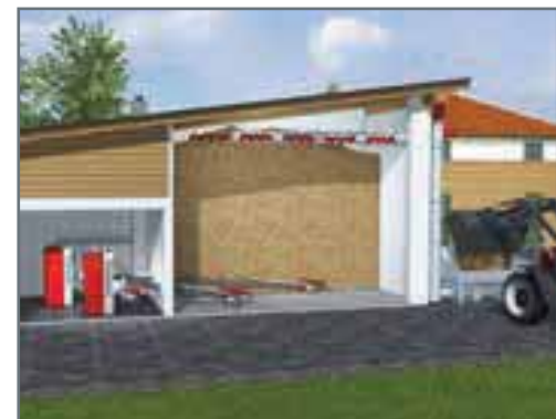
Remplissage par vis verticale puis vis horizontale en cas de traversée d'une pièce ou d'un local rectangulaire allongé
