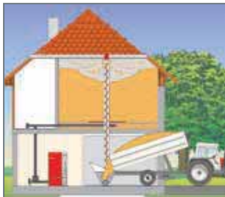
Grand silo au 1 er étage avec remplissage par vis verticale et alimentation de la chaudière par tube de chute au RdC.
