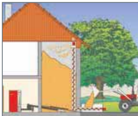
Grand silo de plain-pied avec remplissage par vis verticale.
