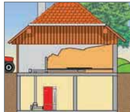
Silo au 1 er étage avec remplissage direct et alimentation de la chaudière par tube de chute au sous-sol.
