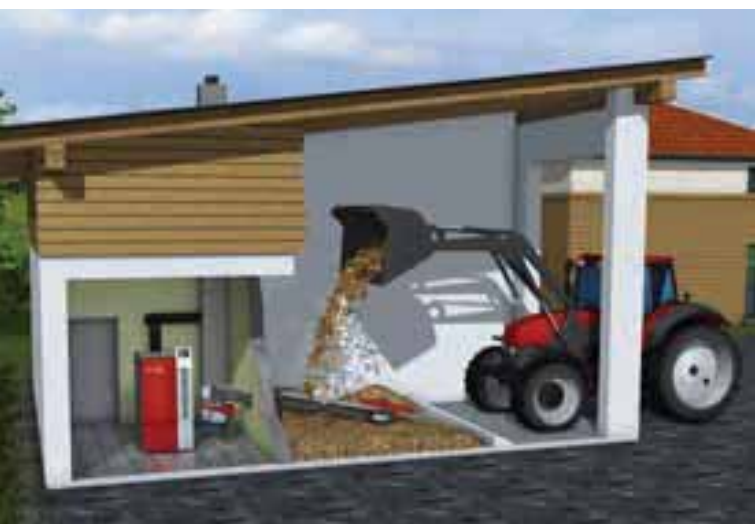
Chaudière et silo mitoyens et de plain-pied :
