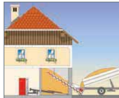
silo de plain-pied avec remplissage par vis inclinée.
