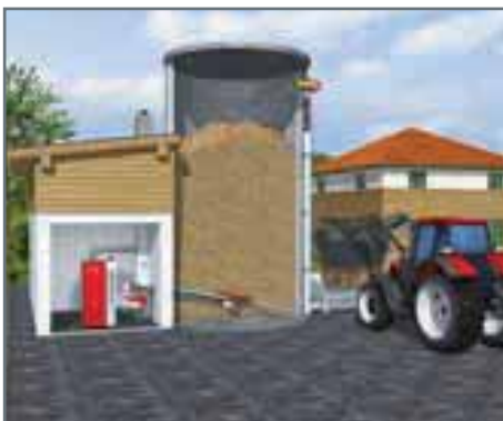
La 1 ère vis horizontale transfère le bois au pied de la vis verticale qui le remonte à grande vitesse dans le silo.
