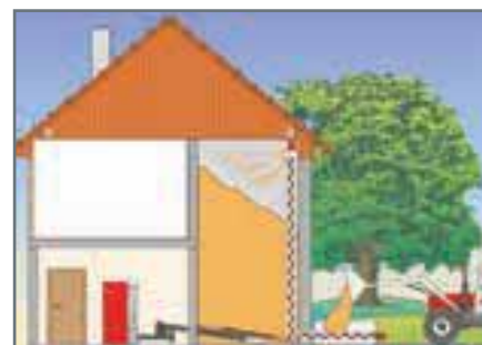
Remplissage d'un silo sur 2 niveaux.
